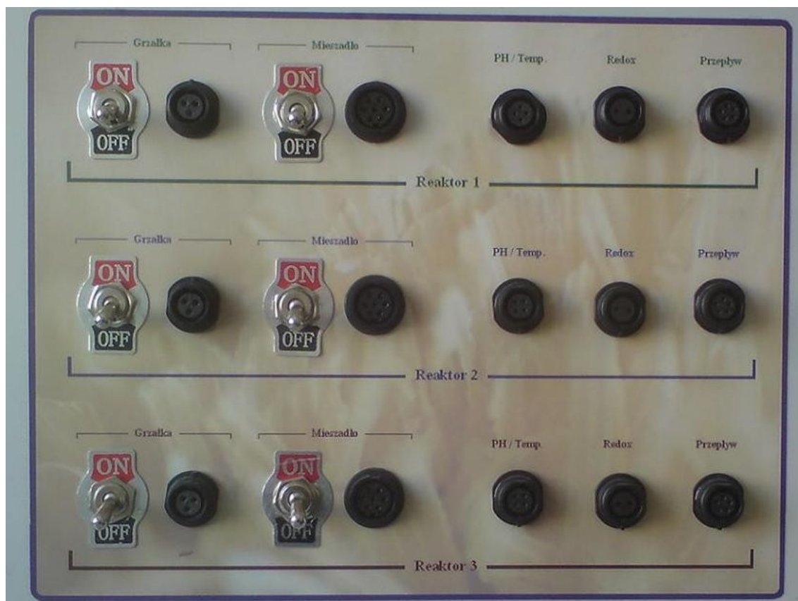
Ilustracja 2: Rozmieszczenie złącz (wyłączników) skrzynki sterowania
