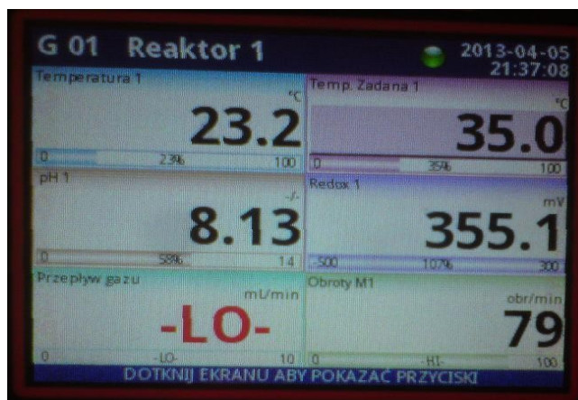
Ilustracja 3: Widok obrazu Grupy 01 "Reaktor 1" (tryb wartości liczbowe)
